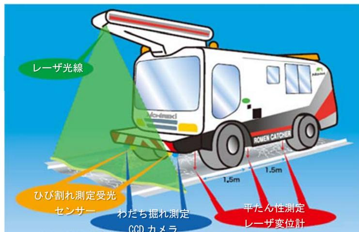
図：路面性状測定車による測定イメージ図
