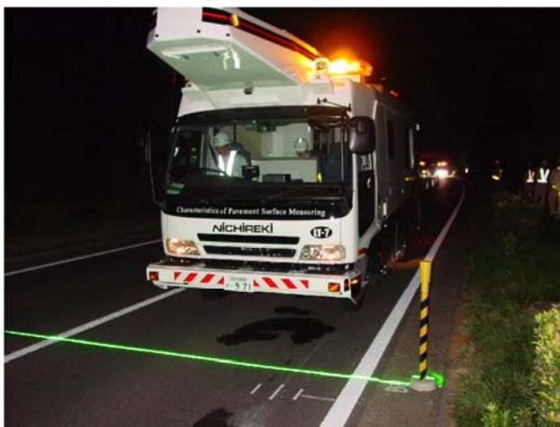
写真：路面性状測定車による測定状況
