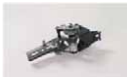
ランクル200、2列目 シートクッションの折り畳 み用のヒンジ機構
