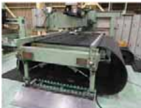
工場内機械：ゴムベルトショット加工
