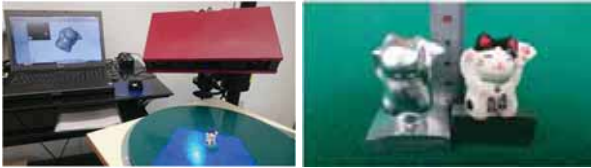
3Dスキャナーで撮影したデータをCADデータ化。 そのデータからジュラルミンで複製
