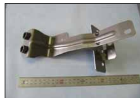
パワーステアリング制御装置 取付部品(150tプレス3工程、3部品を溶接加工)
