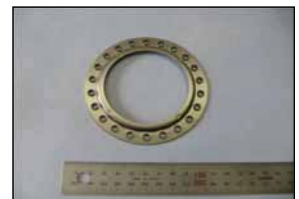
トランスミッション部品 (110tプレス4工程)
