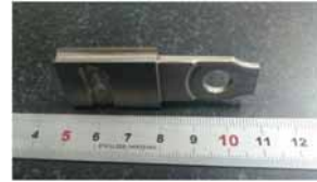
金型のピンです。 精度は±0.02mm 材質は高硬度材（HRC50）
