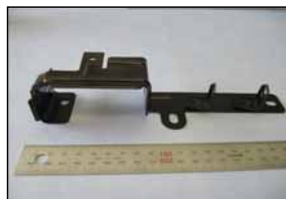
車載用バッテリー取付用部品 (150tプレス4工程、溶接加工後に表面処理加工)
