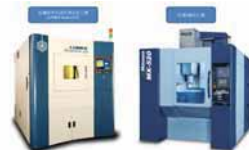
ハイブリッド金属3Dプリンター（左）、同時5軸加工機（右）による最先端加工が可能
