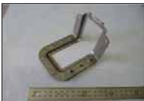
シート部品(110tプレス6工程)
