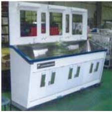
手術室の手洗い設備。膝で押すことにより洗浄水を出します。
