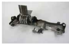
アルファード3列目 シートクッションの折 り畳みヒンジ機構
