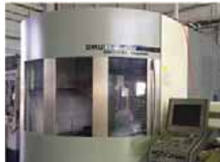
同時5軸加工機による 最先端加工が可能
