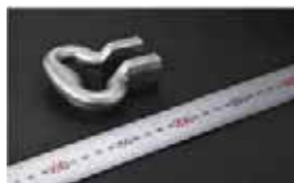
材質：SCM440 熱処理：完全焼なまし処理
