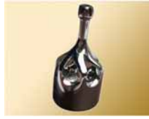
2014年全日本製造業コマ大 戦出場メイクコマ（メタル3Dプリント工法+鏡面研磨）
