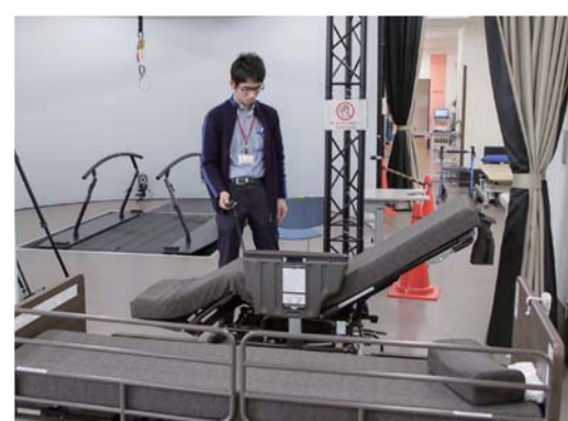
▲車椅子に変形する離床補助ベッド
