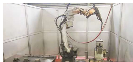
ロボット溶接機
