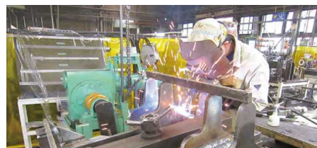
溶接加工(ハンド溶接)
