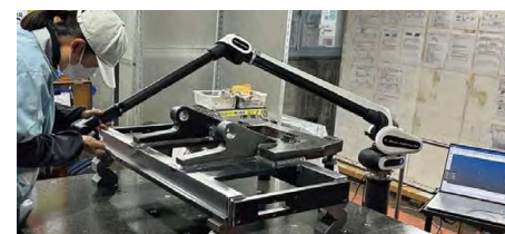
溶接加工品の三次元測定
