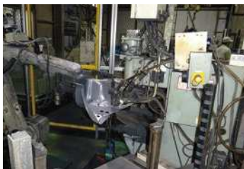
ロボット化されたスポット溶接
