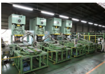
ロボット化されたプレス加工
