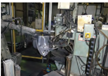
ロボット化されたスポット溶接
