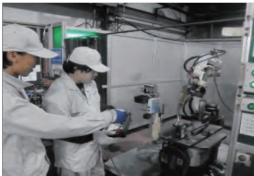
ロボット溶接
