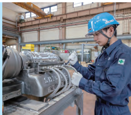
遠心分離機の整備
