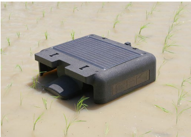
写真左：自動抑草ロボット（アイガモロボ）井関農業株式会社、写真右：おおぶニック学校給食米の圃場
